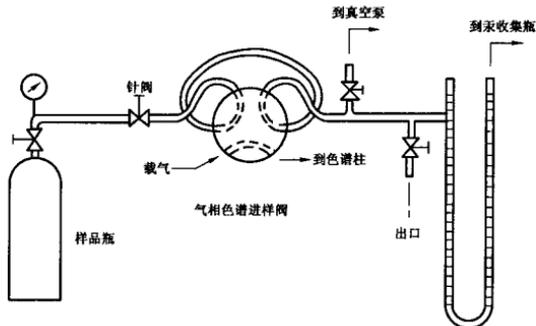
图 1 用于真空下进样的管线排列
